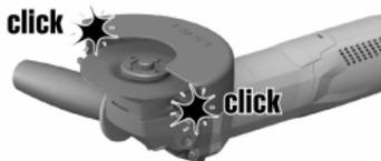
1. Coloque la tapa delantera con el lateral cerrado sobre la caperuza protectora estándar hasta que el cierre se enclave.
