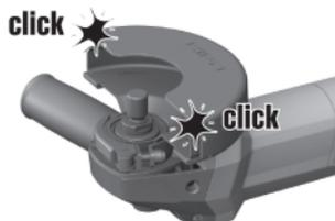
1. Coloque a tampa dianteira com o lado fechado sobre o resguardo de origem até que o fecho engate.
