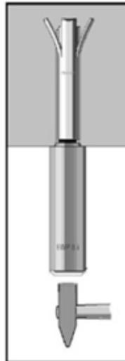
3. Spreizhülse mit Maschinensetzwerkzeug oder Hammer einschlagen.
