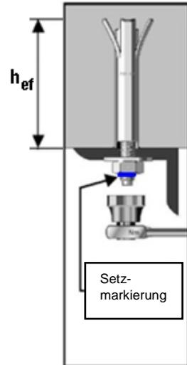
4. Anzugsdrehmoment aufbringen bis die blaue Setzmarkierung sichtbar wird. Drehmoment beim Verankern siehe Zulassung Z-21.1-1729.
