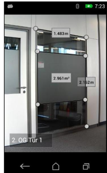
5. **Documenter une distance exacte :** Appuyer sur l'icône de la ligne, pour mesurer une distance
