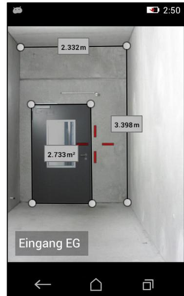
**Genauigkeit:** Unter der Voraussetzung, dass mit der Funktion exakt im 90°Winkel und horizontal auf eine flache Fläche gemessen wurde, beträgt die Genauigkeit der Schätzungen +/- 5%
