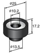
**Technische Daten** für Schalldämpfer MVI-B
