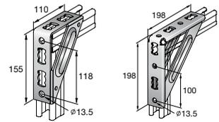
**Technische Daten** für Winkelkonsole (A4 Edelstahl) MQW-S-R
