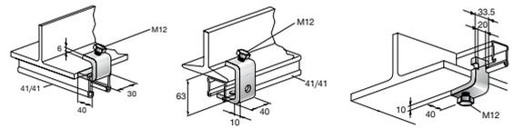
**Technische Daten** für Trägerklammer feuerverzinkt MQT-C-F
