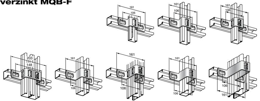
**Technische Daten** für Bride (Schiene an Schiene) feuerverzinkt MQB-F
