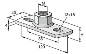
**Technische Daten** für Standard-Grundplatte (metrisch) MGS 2
