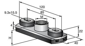
**Technische Daten** für Schalldämmgrundplatte MGS 2-I
