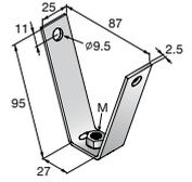
**Technische Daten** für Trapezblech-Montagehänger MF-TSH
