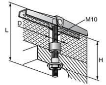
**Technische Daten** für Schwerlast-Kippdübel FD-M10
