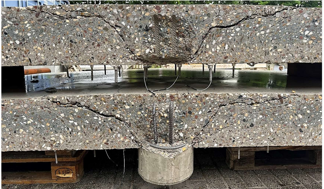
Abbildung 4: Flachdeckenproben, die die Bildung von Schubrisen und den Kegelstumpf verdeutlichen © Hilti
