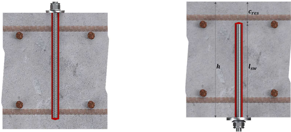
Figure 18: Schéma simplifié du système de renforcement au poinçonnement HIT-Punching shear installé au-dessus (à gauche) ou en dessous (à droite) de l'élément en béton.
