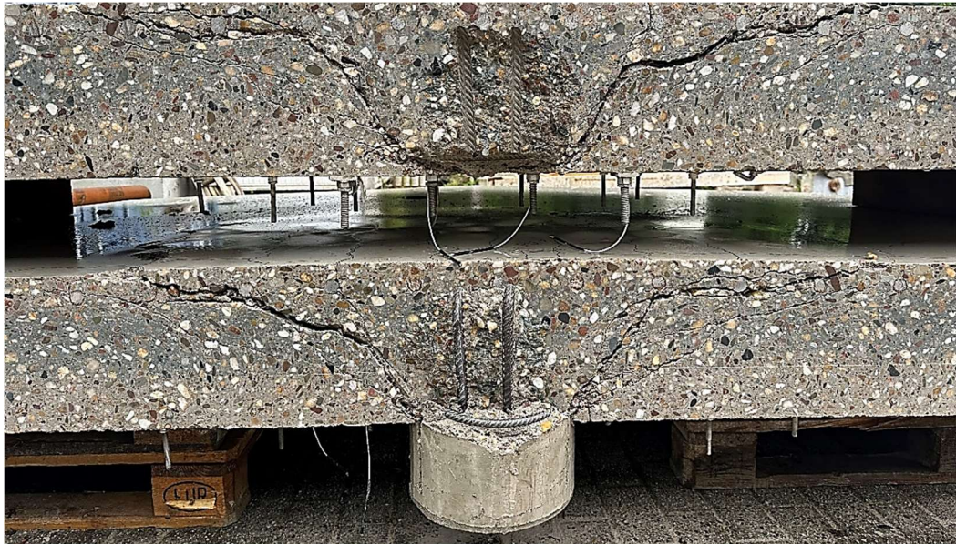
Figure 4: Échantillons de dalles plates mettant en évidence la formation de fissures de cisaillement et le cône tronqué © Hilti
