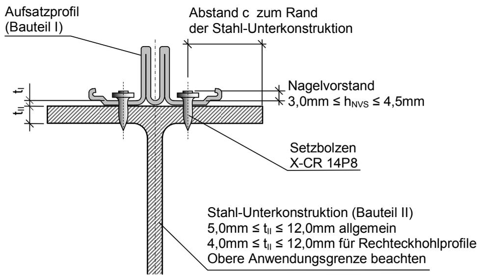
**Tabelle 6:** Aufsatzprofil und Unterkonstruktion (vgl. Anlagen 1 - 5)
