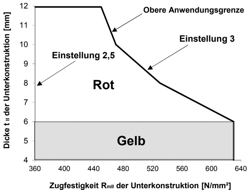
**Ermittlung der optimalen Setzenergieeinstellung am Bolzensetzgerät Hilti DX 450 (125%): Vorgehen**
