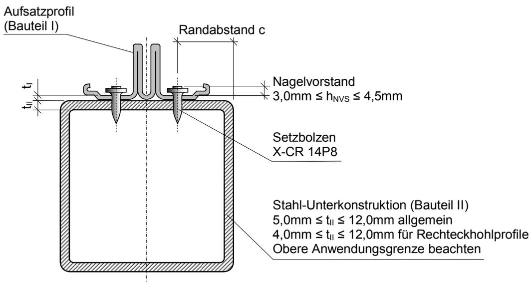
Hilti Setzbolzen X-CR 14P8 aus korrosionsbeständigem Stahl zur Befestigung von Aufsatzprofilen im Fassadenbau
