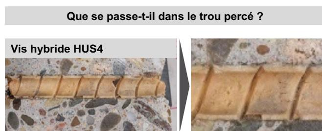
Figure 3 Contre-dépouille réalisée dans le béton avec une vis hybride Hilti HUS4
