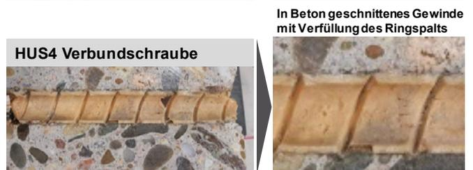
Abb. 3 Erzeugter Hinterschnitt im Beton mit Hilti Verbundschraube HUS4
