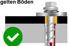
Abb. 8 Hilti Betonschraube HUS4 mit Verbundpatrone (Verbundschraube) HUS4-MAX für die Befestigung von Anlagen und Gebäudeausrüstung und die damit verbundenen konstruktiven Vorteile wie kleinste Rand- und Achsabstände, Schutz des Bohrlochs vor Feuchtigkeit und verschiedenen Substanzen bei versiegelten Böden und volle Ausbaubarkeit
