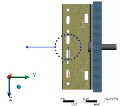
La force de réaction est évaluée au point distant de l'application de la charge.
