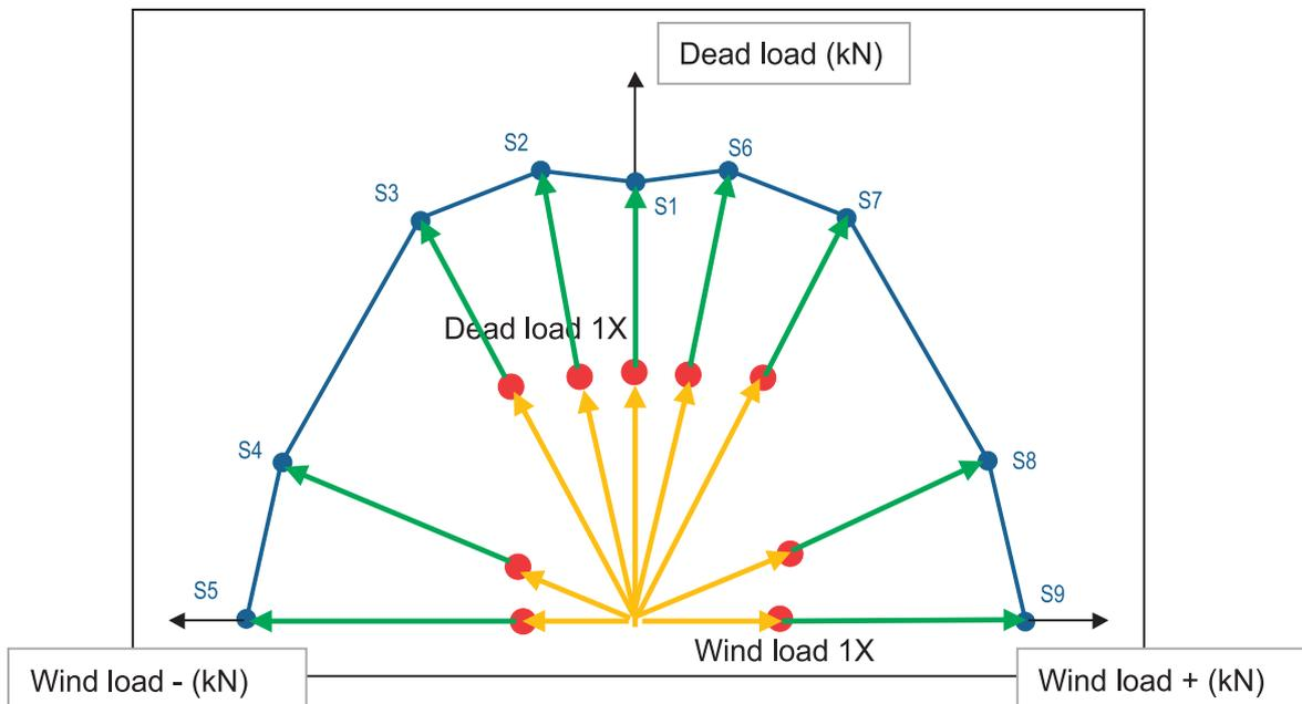
Les points rouges représentent une charge permanente et une charge du vent de 100 % (charge de conception). Au-delà de ce point, la charge de déplacement a été appliquée jusqu'à ce que l'un des critères de défaillance mentionnés ci-dessus soit atteint. Dans le graphe, on considère qu'après que le système ait atteint un comportement non linéaire, les forces n'augmentent pas avec la même intensité ; par conséquent, les flèches vertes ne seront pas redressées pour obtenir un graphe symétrique.
