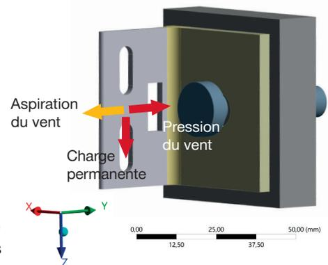
Combinaison de la charge permanente et de la charge du vent pour différents cas de charge.
