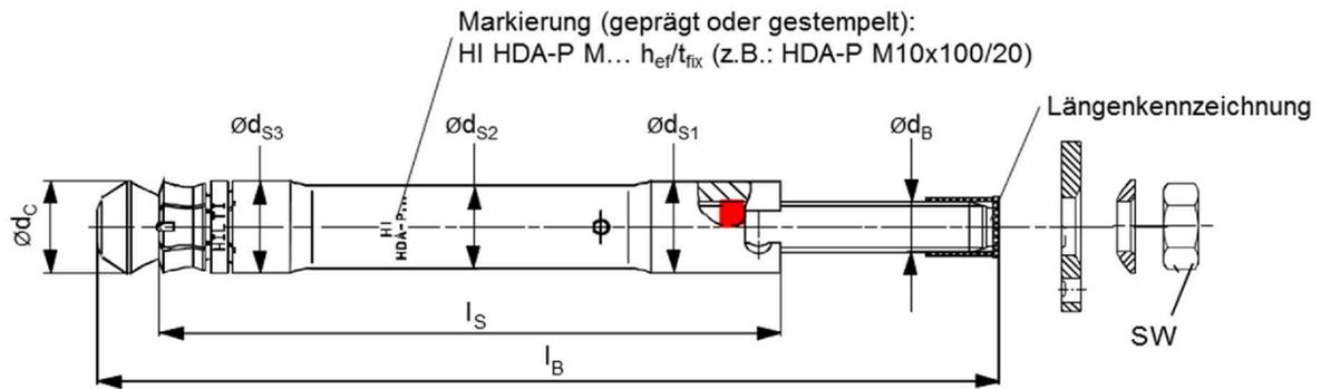
**Bild 9:** Durchsteckdübel HDA-T(R)
