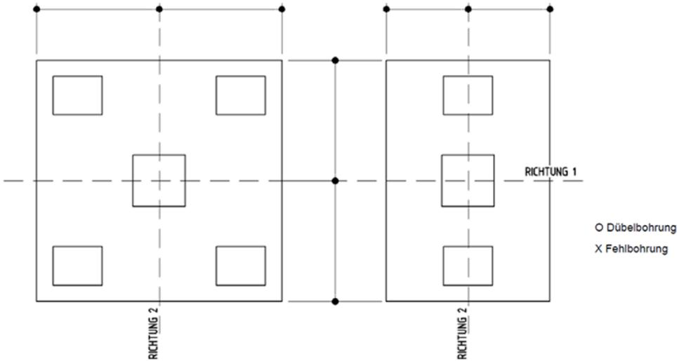
Bei Platten am Boden oder Decke ist die Orientierung zum Raum/Bauwerksachsen anzugeben, bei Wandmontage ist das Höhenknotenzeichen  $\nabla$  an die horizontale Achse anzutragen!
