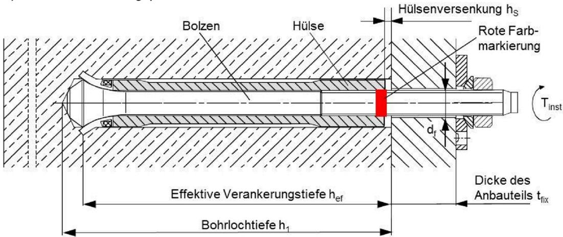
b) optional: Ringspalt mit Injektionsmörtel HIT-HY 200-A oder HIT-HY 200-A V3 verfüllt
