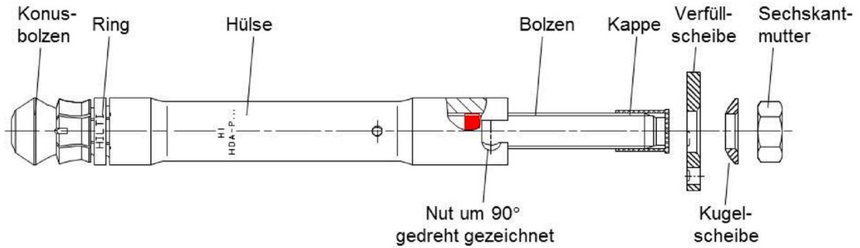
**Bild 2:** Vorsteckdübel HDA-P(R): Einbauzustand
