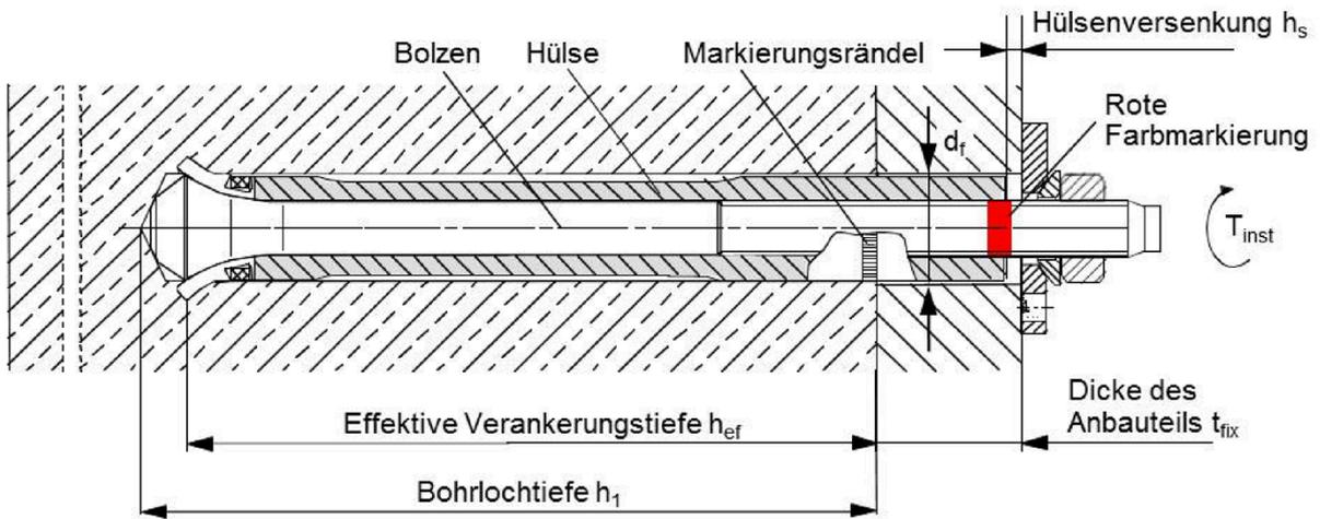
b) optional: Ringspalt mit Injektionsmörtel HIT-HY 200-A oder HIT-HY 200-A V3 verfüllt
