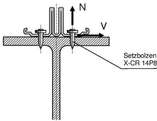
Hilti Setzbolzen X-CR 14P8 aus korrosionsbeständigem Stahl zur Befestigung von Aufsatzprofilen im Fassadenbau
