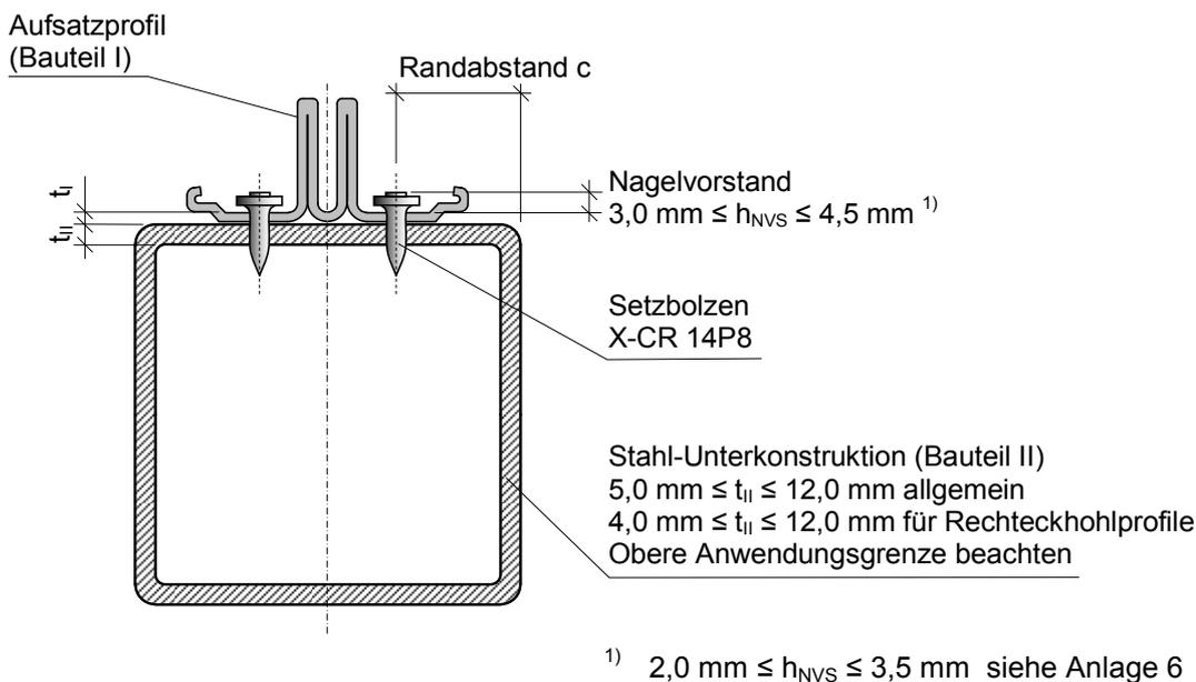
Hilti Setzbolzen X-CR 14P8 aus korrosionsbeständigem Stahl
