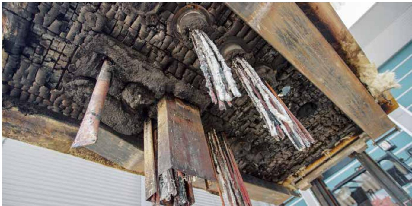
Brettsperrholz-Prüfkörper nach einer Feuerwiderstandsprüfung nach EN1366-3
