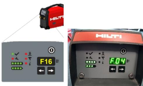
Alette F-Kodu gösteriliyor. The image shows a red Hilti F-BT device and its control panel. The panel displays the text 'F16' and has several indicator lights and buttons. A callout points from the text 'Alette F-Kodu gösteriliyor' to the device. | <b>KABUL EDİLEMEZ:</b><br>Kaynak sonrası F-Kodunun gösterildiği saplamalar.<br><br>→ Burada belirtilen eylemleri gerçekleştirin: Tablo 6 | Tablo 6'da belirtilen F-Kodlarına göre düzeltici eylemler. |               |
