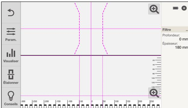
Cette fonction permet de localiser les fers d'armature dans le béton et d'autres matériaux de construction non ferreux et de les afficher en temps réel. Les fers d'armature perpendiculaires au sens de balayage peuvent être visualisés en vue du dessus et vue en coupe et peuvent être marqués directement sur la surface examinée à l'aide des encoches de repère.
