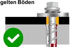
Abb. 9 Hilti Betonschraube HUS4 mit Verbundpatrone (Verbundschraube) HUS4-MAX für die Befestigung von Anlagen und Gebäudeausrüstung und die damit verbundenen konstruktiven Vorteile wie kleinste Rand- und Achsabstände, Schutz des Bohrlochs vor Feuchtigkeit und verschiedenen Substanzen bei versiegelten Böden und volle Ausbaubarkeit
