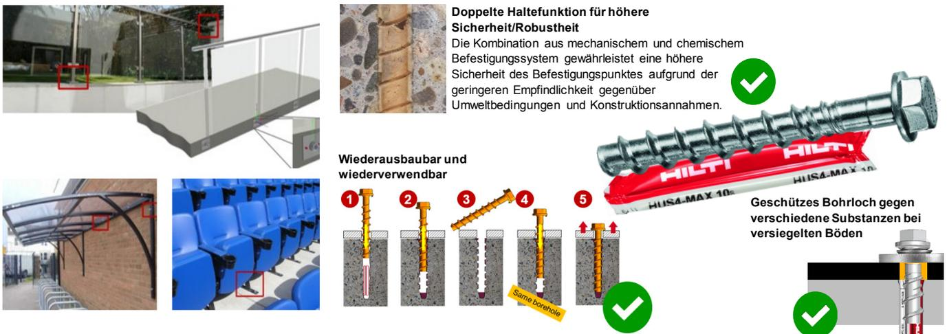
**Abb. 8** Hilti Betonschraube HUS4 mit Verbundpatrone (Verbundschraube) HUS4-MAX für sicherheitsrelevante Anwendungen und die damit verbundenen konstruktiven Vorteile wie kleinste Rand- und Achsabstände, Schutz des Bohrlochs vor Feuchtigkeit und volle Ausbaubarkeit
