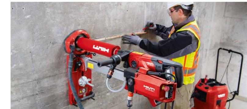
Parallèlement, elles communiquent via Bluetooth avec le système de gestion de l'eau. Enfin, pendant que la machine termine l'opération de forage, l'opérateur peut d'ores et déjà effectuer le marquage pour le forage suivant ou mettre en place une cheville. Augmentez la productivité de travail grâce à cette technologie de forage semi-automatique.
