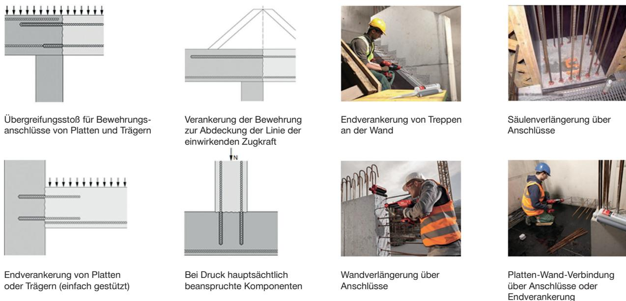
Übergreifungsstoß für Bewehrungsanschlüsse von Platten und Trägern
