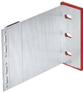
Wandkonsolen sind sowohl für Fest- als auch Gleitpunkte ausgelegt, sodass eine thermische Ausdehnung des Profils gewährleistet ist. Der Festpunkt übernimmt das Eigengewicht der Bekleidung, der Unterkonstruktion und die anteiligen Windlasten, der Gleitpunkt übernimmt hingegen nur die anteiligen Windlasten.
