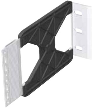
Die Wandkonsolen sind sowohl für Fest- als auch Gleitpunkte ausgelegt, sodass eine thermische Ausdehnung des Profils gewährleistet ist. Der Festpunkt übernimmt das Eigengewicht der Bekleidung, der Unterkonstruktion und die anteiligen Windlasten, der Gleitpunkt übernimmt hingegen nur die anteiligen Windlasten.
