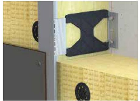
Die Wandkonsolen sind sowohl für Fest- als auch Gleitpunkte ausgelegt, sodass eine thermische Ausdehnung des Profils gewährleistet ist. Der Festpunkt übernimmt das Eigengewicht der Bekleidung, der Unterkonstruktion und die anteiligen Windlasten, der Gleitpunkt übernimmt hingegen nur die anteiligen Windlasten.
