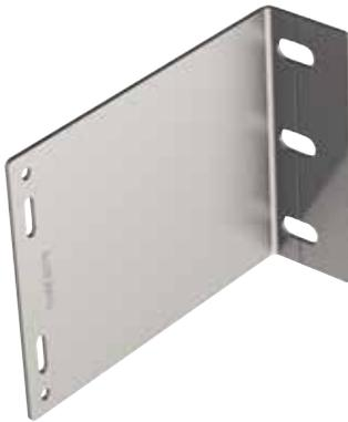
Wandkonsolen sind sowohl für Fest- als auch Gleitpunkte ausgelegt, sodass eine Wärmeausdehnung des Profils gewährleistet ist. Der Festpunkt übernimmt das Eigengewicht der Bekleidung, der Unterkonstruktion und die anteiligen Windlasten, der Gleitpunkt übernimmt hingegen nur die anteiligen Windlasten.
