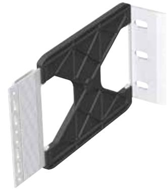
Das Justieren der Profile an den Wandkonsolen wird durch einen Helfer wesentlich erleichtert, da der Helfer die Profile bereits in der gewünschten Position hält und somit das Verschrauben der Profile mit den Konsolen erheblich erleichtert. Mit diesem System können Wandtoleranzen von bis zu 40 mm perfekt ausgeglichen werden. Die Konsolen sind von 140 bis 320 mm Länge erhältlich. Um Kontaktkorrosion zu vermeiden wird die Konsole mit pulverbeschichteter Grundplatte geliefert.
