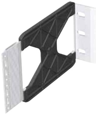
Die Verbindung der vertikalen Profile mit den Konsolen erfolgt über speziell für Fest- und Gleitpunkte entwickelte Schrauben. Dadurch ist ein nahezu reibungsloses Gleiten der Profile im Verhältnis zu den Wandkonsolen möglich. Ausserdem wird so das Profil beim Festpunkt in seiner Lage blockiert. Der Gleitpunkt stellt sicher, dass keine Zusatzbelastungen auf die Unterkonstruktion einwirken, die infolge von Spreizkräften entstehen, die vom Profil ausgehen.
