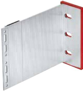
Die Wandkonsolen sind sowohl für Fest- als auch Gleitpunkte ausgelegt, sodass eine thermische Ausdehnung des Profils gewährleistet ist. Der Festpunkt übernimmt das Eigengewicht der Bekleidung, der Unterkonstruktion und die anteiligen Windlasten, der Gleitpunkt übernimmt hingegen nur die anteiligen Windlasten.
