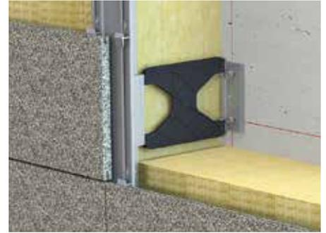
Die Wandkonsolen sind sowohl für Fest- als auch Gleitpunkte ausgelegt, sodass eine thermische Ausdehnung des Profils gewährleistet ist. Der Festpunkt übernimmt das Eigengewicht der Bekleidung, der Unterkonstruktion und die anteiligen Windlasten, der Gleitpunkt übernimmt hingegen nur die anteiligen Windlasten.
