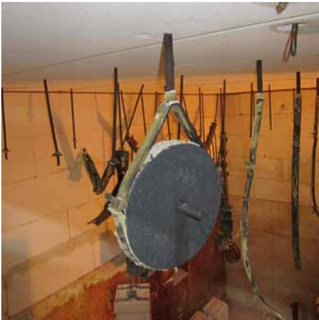
Bild F-XV-6: Rohrschelle vor und nach dem Brandversuch (Werkbild Hilti)
