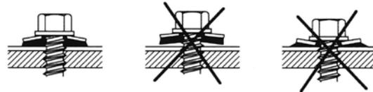
Um sicherzustellen, dass die Dichtscheibe viele Jahre lang ihre Funktion erfüllt, ist das korrekte Setzen der Schraube unerlässlich.
