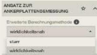
Le dimensionnement des platines proche de la réalité peut être activé pour les actions statiques et sismiques. Dans l'onglet « Charges », vous trouverez l'« approche pour la conception de la platine ». Modifiez-la de rigide (hypothèse d'une platine rigide) à proche de la réalité.
