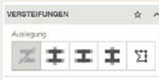
Vous pouvez sélectionner des raidisseurs et les positionner pour augmenter la rigidité de votre platine. Il y a 3 positions de renfort différentes prédéfinies.
