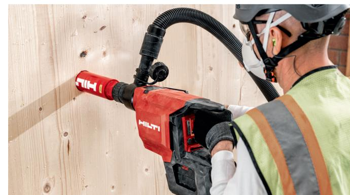
Poiché l'attrito nel foro è minimo e l'area di perforazione è efficacemente raffreddata, il rischio di bruciature è ridotto al minimo. La nostra carotatrice a batteria DD 150-22 vi offre una sicurezza ancora maggiore: il sistema ATC integrato impedisce le torsioni improvvise dell'attrezzo.
