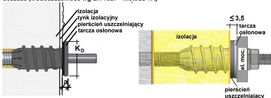
Montaż z zachowaniem maks. odstępu między tynkiem a elementem mocowanym w celu zapewnienia wodoszczelności ( $a \leq 3,5$  mm)
