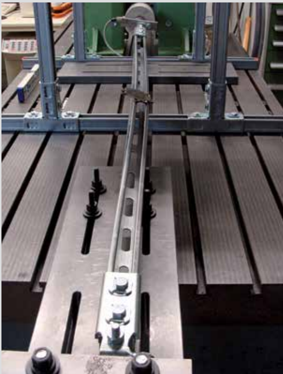
Fig. H.1 : Essai de chargement en compression sur le connecteur MQS-ACD associé à un rail MQ-41
