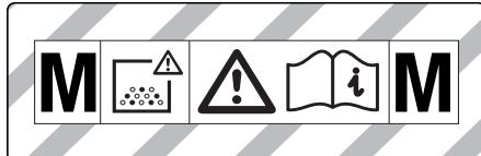
Opozorilo: Ta naprava vsebuje zdravju škodljiv prah. Priznjenje in vzdrževanje naprave, vključno z zamenjavo vrečke za prah, smejo opravljati samo strokovne osebe, ki so opremljene z ustrezno zaščitno opremo. Naprave ne vključujte, dokler ni vgrajen celoten filtrski sistem in ni bilo preverjeno funkcioniranje volumskega pretoka.
